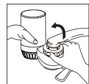
Setzen Sie die Filterbasis in die Montagebasis ein und drehen Sie sie um 90° nach oben.
