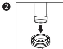
Haal het nieuwe filter eruit en druk het in de filterbasis. Zorg ervoor dat de afdichtring op zijn plaats zit.
