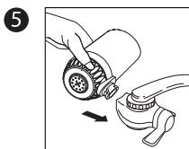
Lijn de sleuf van de filterbasis uit met de sleuf van de montagebasis.
