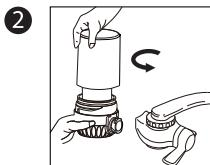
Draai de filtertopafdekking los en haal het oude filter eruit.
