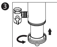
Draai de filterbasis met de filtertopafdekking.
