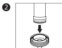
Wyjmij nowy filtr i wcisnij go do podstawy filtra. Upewnij się, że pierścień uszczelniający jest na swoim miejscu.
