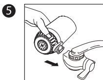
Alinee la ranura de la base del filtro con la ranura de la base de montaje.
