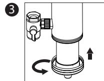
Drehen Sie die Filterbasis mit der Filteroberseite ab.
