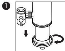
Drehen Sie die Filterbasis ab und entfernen Sie den abgelaufenen Filter.
