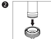
Nehmen Sie den neuen Filter heraus und drücken Sie ihn in die Filterbasis. Stellen Sie sicher, dass der Dichtungsring an Ort und Stelle ist.
