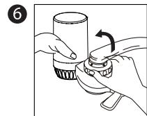
Włóż podstawę filtra do podstawy montażowej i obróć ją o 90° w górę.
