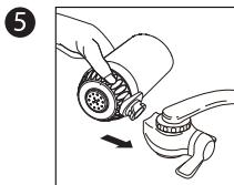
Wyrównaj szczeleń podstawy filtra z szczeleń podstawy montażowej.
