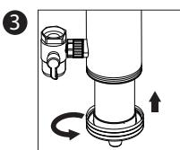
Odkręć podstawę filtra z pokrywą górną filtra.
