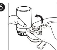
Setzen Sie die Filterbasis in die Montagebasis ein und drehen Sie sie um 90° nach oben.
