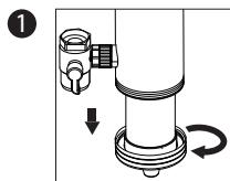
Draai de filterbasis los en verwijder het verlopen filter.
