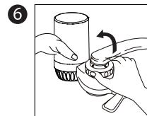
Sätt i filterbasen i monteringsbasen och rotera 90° uppåt.
