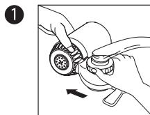
Drehen Sie die Filterbasis von der Montagebasis ab.
