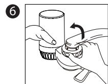
Inserte la base del filtro en la base de montaje y gire 90° hacia arriba.
