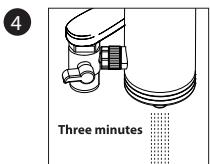
Basculez le levier en position niveau et rincez pendant 3 minutes. La méthode d'installation des autres systèmes de filtration de robinet est la suivante .
