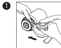
Odkręć podstawę filtra od podstawy montażowej.
