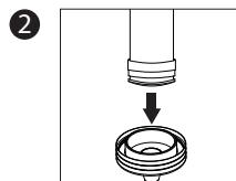
Sortez le nouveau filtre et appuyez dessus dans la base du filtre. Assurez-vous que le joint d'étanchéité est en place.
