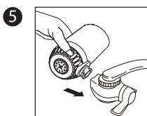
Richten Sie den Schlitz der Filterbasis mit dem Schlitz der Montagebasis aus.
