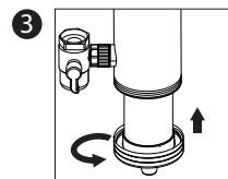
Gire la base del filtro con la cubierta superior del filtro.
