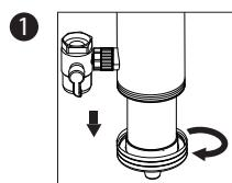
Odkręć podstawę filtra i usuń przeterminowany filtr.
