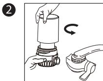
Odkręć pokrywę górną filtra i wyjmij stary filtr.
