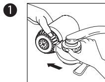
Draai de filterbasis los van de montagebasis.
