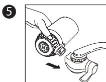
Alignez la fente de la base du filtre avec la fente de la base de montage.
