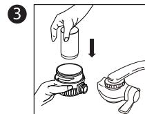
Yenifiltreyifiltre tabanına yerleştirin.
