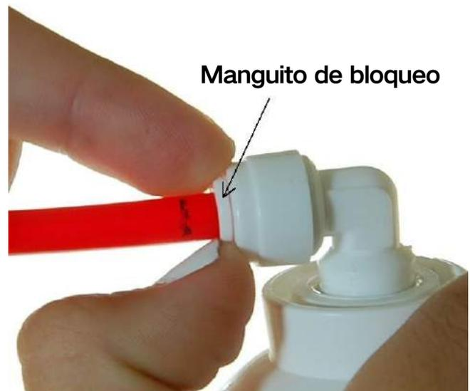
Con dos dedos EMPUJANDO HACIA DENTRO y PRESIONANDO HACIA ABAJO el manguito de bloqueo, extraiga el tubo
