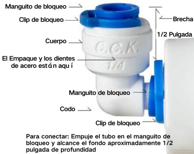
Para conectar: Empuje el tubo en el manguito de bloqueo y alcance el fondo aproximadamente 1/2 pulgada de profundidad
